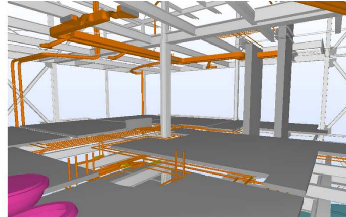
Integrazione strutture impianti
